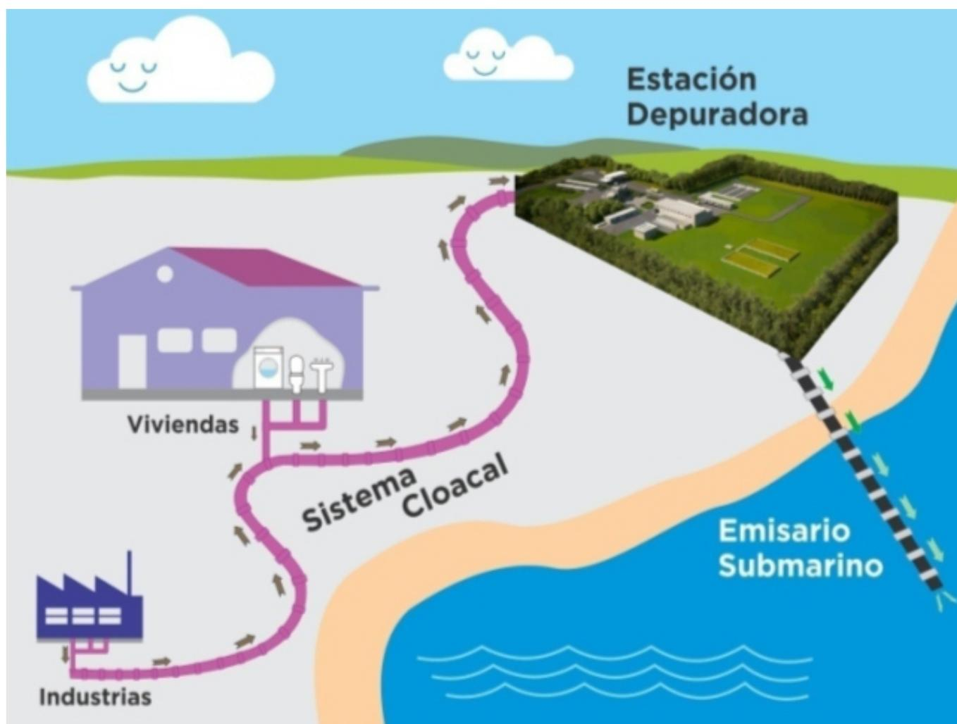
Luego, estas colectoras generales descargan estos líquidos en alguna de las cuatro cloacas máximas existentes en la ciudad, que transportan el efluente hasta la Planta Depuradora, lugar donde se separan grasas y sólidos, para ser luego volcado al mar, el líquido residual, a través del Emisario Submarino.
