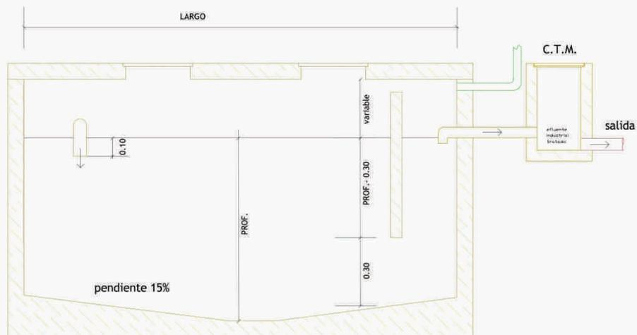
**DETALLE INTERCEPTOR-DECANTADOR esc 1:25**
